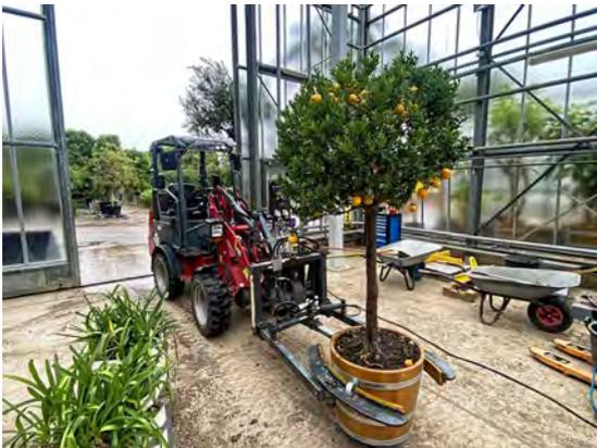
Seit 2017 wird der oben abgebildete elektrisch betriebene „Hoftrac“ mit hydraulischer Kübelzange eingesetzt. Dieser ermöglicht es, runde Eichenkübel mit Durchmesser von 40 bis 70 cm arbeitswirtschaftlich und nachhaltig zu transportieren.
